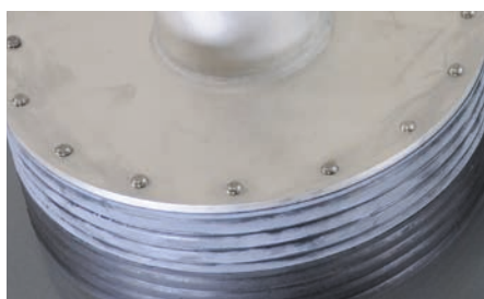
Ancienne version avec filetages M8 normaux
