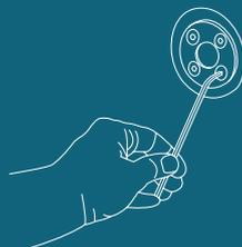
Grundelement bündig zur Beckenoberfläche setzen, Schrauben anziehen.
