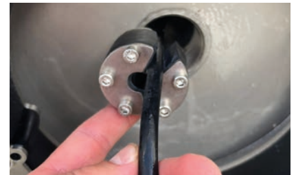
2. Setzen der Press & Close-Kabeldichtung nach dem Einziehen des Kabels
