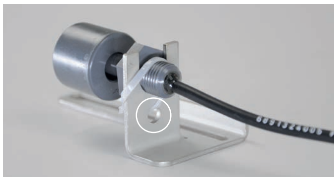
Schwimmerhalterung – neu mit Loch für die Befestigung des Schwimmers ohne Kontermutter (z. B. wenn vergessen geht, diese einzufädeln), für alle Skimmer.
