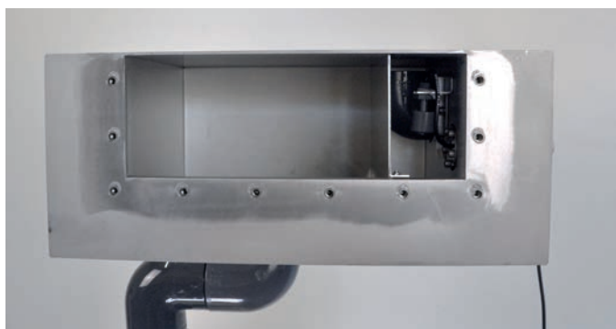
Skimmer Ultima GF Front mit elektronischem Niveaugler.
